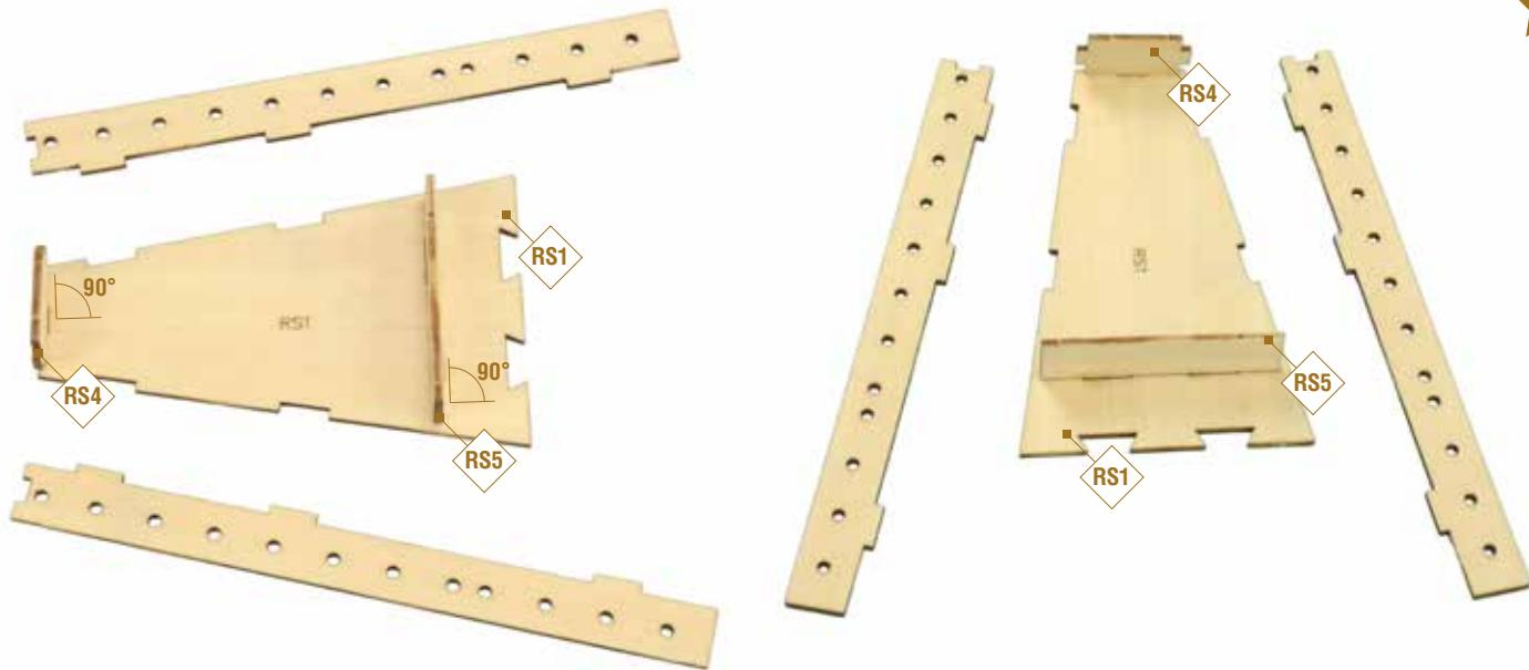
2. Установите и приклейте **детали RS4 и RS5** на указанные на фотографии места. Проверьте, чтобы детали были установлены под прямым углом.
